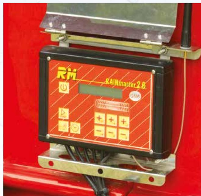
I programmatori elettronici RM sono stati progettati per una perfetta integrazione sulla macchina irrigatrice, dando priorità alla semplicità d'uso e **con un display istintivo e multilingue**, può essere facilmente escluso senza interrompere il ciclo irriguo della macchina, per passare dal funzionamento automatico a quello manuale.
