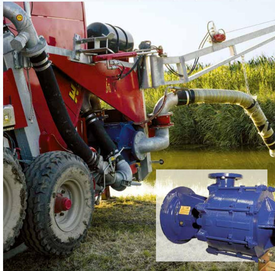
La pompa nelle macchine irrigatrici della gamma XJM è il cuore pulsante del funzionamento, per questo oltre alla vasta scelta determinata dalla collaborazione con i più importanti produttori nazionali, **RM produce in proprio una gamma di pompe centrifughe pluristadio particolarmente innovative, dotanti di grandi multicellulari, con la stessa cura e l'identica qualità che si ritrovano nelle macchine irrigatrici.**
