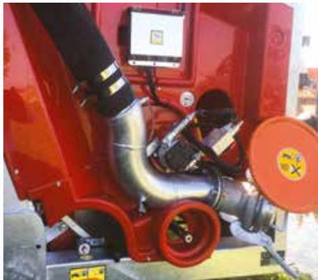
Riavvolgimento del tubo con motore diesel YANMAR LD70 completo di trasmissione idrostatica con motore idraulico sul riduttore, valvola compensatrice di velocità, doppia pompa idraulica per alimentazione dei servizi; abbinabile a programmatori elettronici RM. L'optional sostituisce il riavvolgimento a turbina (solo per mod. Xj).
