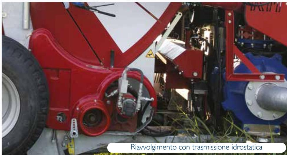
Riavvolgimento con trasmissione idrostatica
