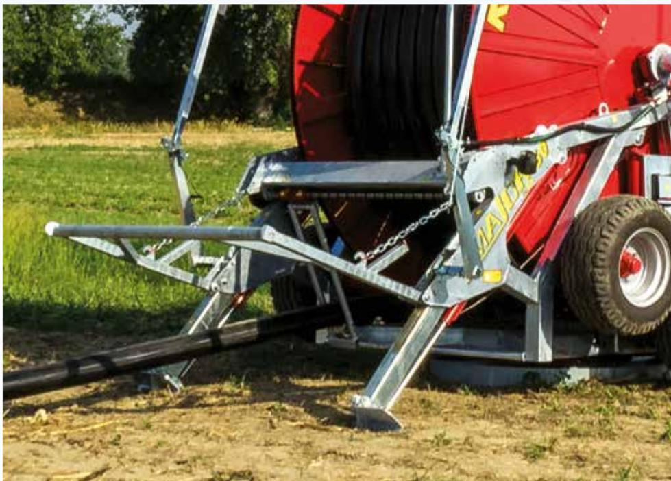
Le macchine irrigatrici RM nella gamma Xj ed Xjm hanno la struttura abbassabile idraulicamente, che determina così due posizioni: su ruote, per consentire il trasferimento su strada, oppure appoggiata al terreno durante la fase di lavoro.
