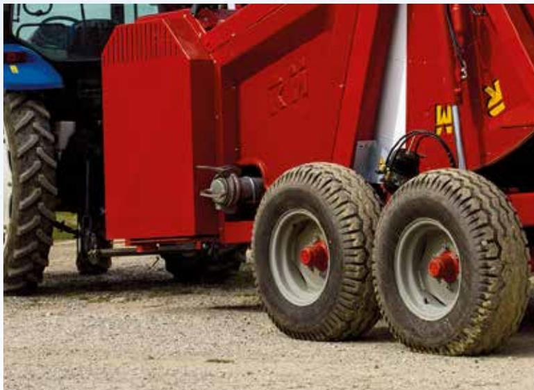
Tutte le macchine della serie XJ e XJM dotate di doppio assale con ruote isodiametriche dispongono del bilanciante asimmetrico; questa soluzione consente un forte riduzione dello sforzo nel traino su terreni difficili, che, accompagnato da un ingombro trasversale ridotto, garantisce anche una migliore ripartizione del peso in fase di sterzata rendendo la macchina più maneggevole del singolo assale.
