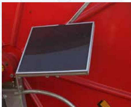
Pannello solare per alimentazione degli apparati elettronici
