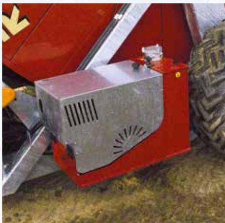
Centralina azionata da motore a 4 tempi HONDA GX160 per servizi oleodinamici.
