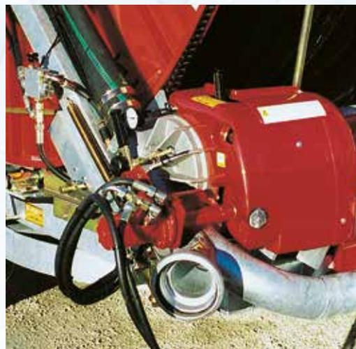
Riavvolgimento del tubo PE mediante motore idraulico su PTO, valvola regolatrice di velocità, distributore finecorsa e coppia innesti rapidi al trattore
