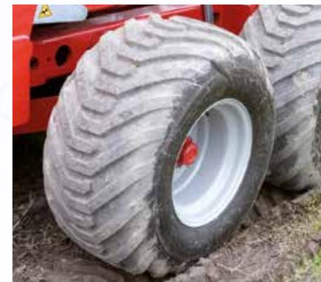
Pneumatico alto galleggiamento per mod. Giant Xj, Giant Xjm (misura 500/50-17)
