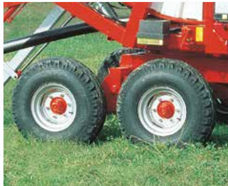
Doppelachse auf asymmetrischem Schwingrad (Zubehör für Mod. 690 Gx, 790 Gx, 890 Gx und 890 Gx Evo).
