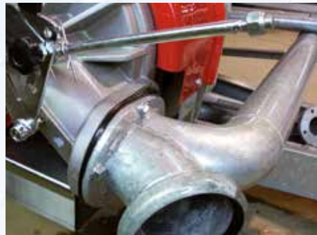
Klarlackierung zum besseren Schutz der verzinkten Teile.
