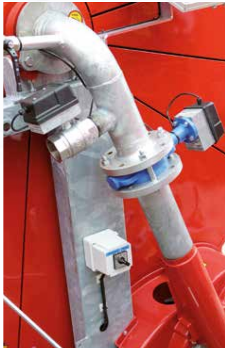
Elektromechanisches Ablassventil und elektromechanisches Schließventil, die vom Programmiergerät gesteuert werden (getrennt oder zusammen geliefert und von elektrischem Umwandler gesteuert).
