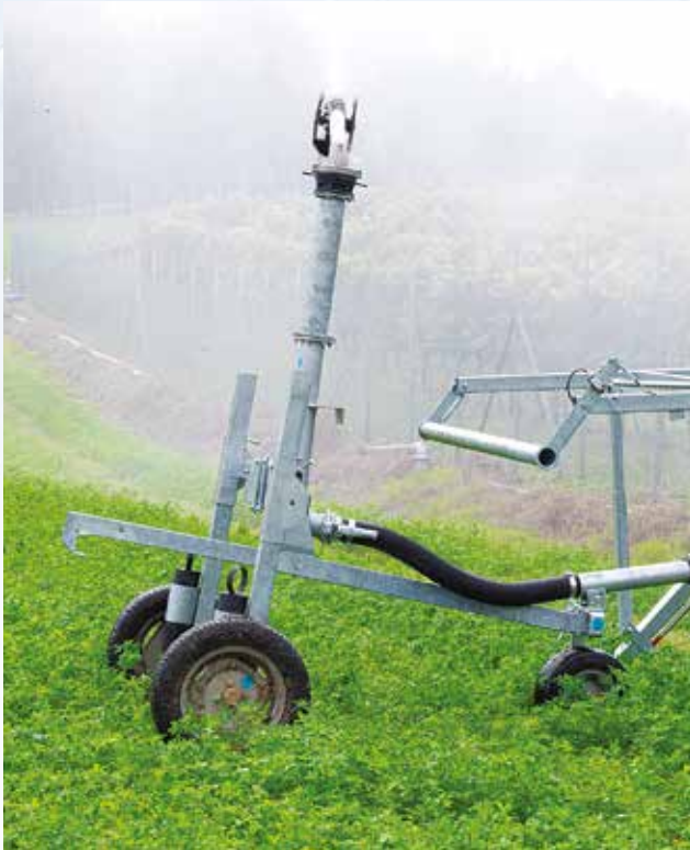
Wagen mit drei bereiften Rädern, an allen Mod. Gx serienmäßig.
