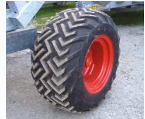
Hochprofilreifen für Mod. 690 Gx Evo und 790 Gx Größe 31x15.50-15
