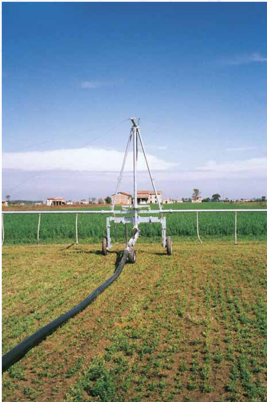
Stahlgestänge für Jauchevertelung zu 28 Metern mit Senkungen
