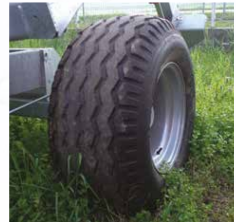
Hochprofilreifen für Mod. 890 Gx, 990 Gx und serienmäßig bei 1100 Gx (Größe 15.0/55-17)
