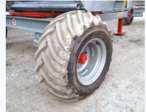
Hochprofilreifen für Mod. 581 Gx Evo Größe 26/12.00-12
