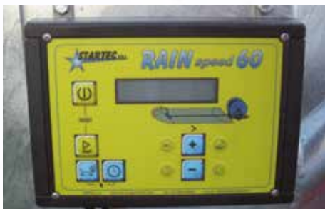
Digitaler Meterzähler STARTEC für die Messung der Aufwickelgeschwindigkeit.
