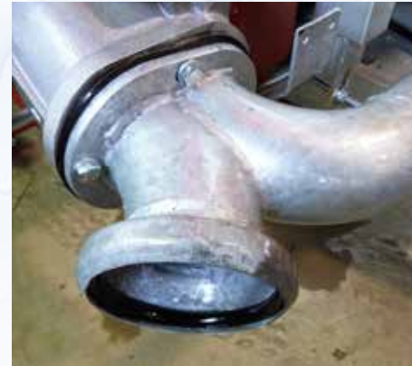
Beidseitiger Wassereintritt. (serienmäßig bei allen Modellen GX ab dem Mod. 581).
