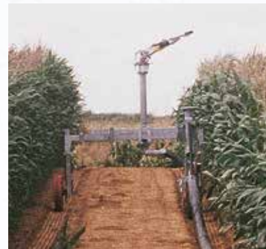
Vorrichtung für Verankerung des Wagens im Boden mit Pickel (für Modelle mit hinterer Schlauchabwicklung)
