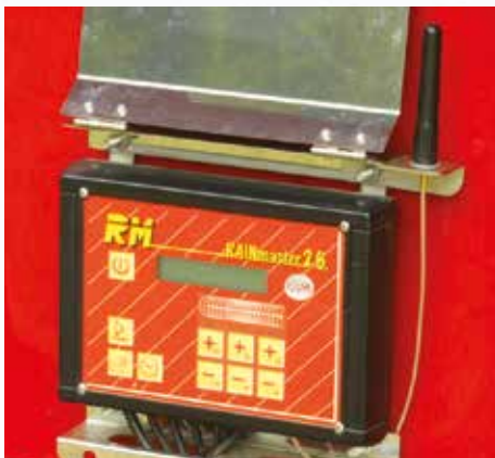
Programmiergerät RM Modell RainMaster 2.6 (mit Antenne und eingebautem optionalem GSM-Modul)
