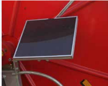
Sonnentafel für die Speisung der elektronischen Geräte
