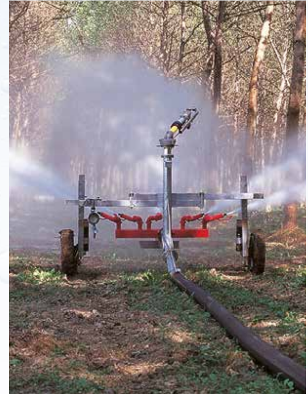
Vorrichtung für Bewässerung unter Baumkronen von hochstämmigen Bäumen.
