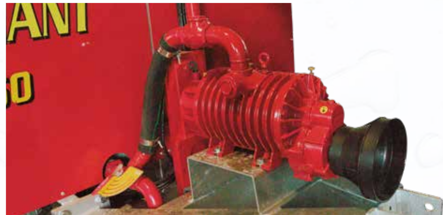
Kompressor für Schlauchentleerung JUROP 9000 lt.
