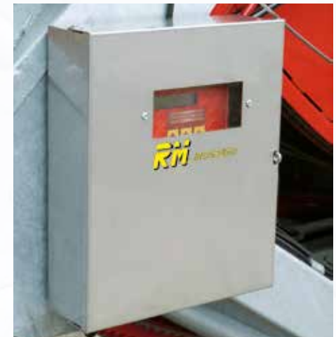
Schutzkasten aus rostfreiem Stahl für Programmiergerät RainMaster 2.6.
