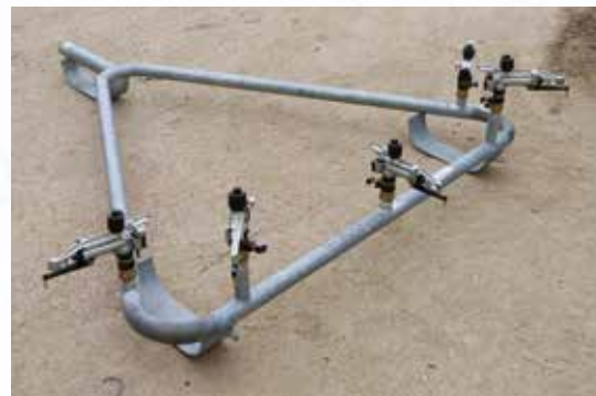
Vorrichtung für Unterkronenberegnung für Obstplantagen/Weinberge anstelle des Standardwagens.
