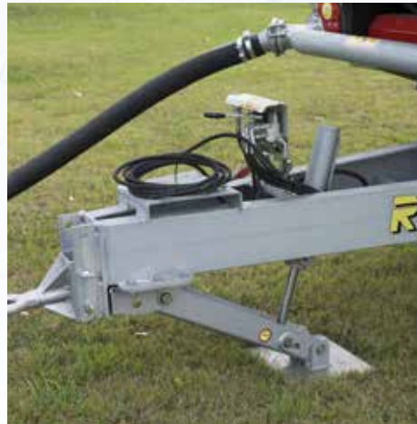
Piede timone idraulico basculante (optional per 790, 890, 990 e 1100 GX).
