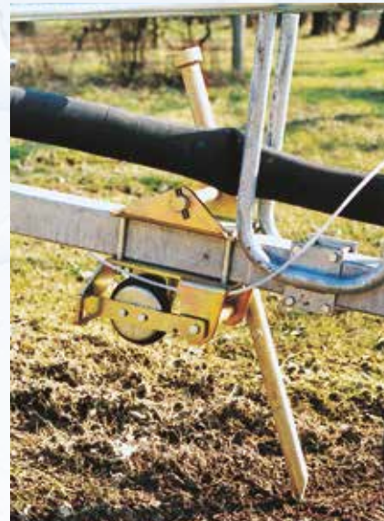
Vorrichtung für Verankerung des Wagens im Boden mit Pickel (für Modelle mit hinterer Schlauchabwicklung)
