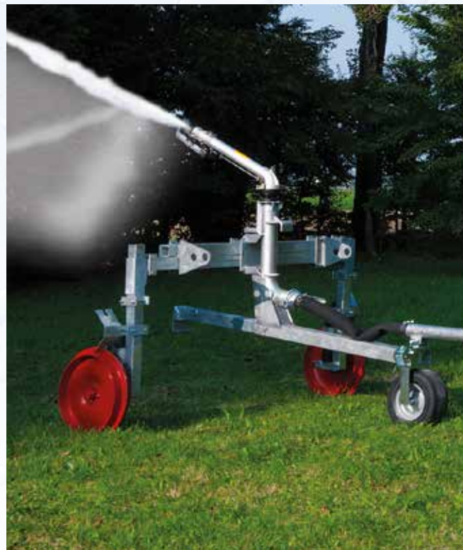
Wózek z pojedynczymi kołami żeliwnymi (w opcji, począwszy od modelu 570 Gx Evo).
