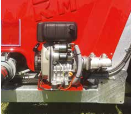
Centralka uruchamiana przez 4-suwowy silnik HONDA GX160 Hp 5,5 do obsługi urządzeń hydraulicznych.
