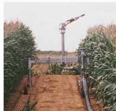
Urządzenie mocujące wózek do terenu za pomocą bolca (dla modeli z tylnym rozwijaniem węża).
