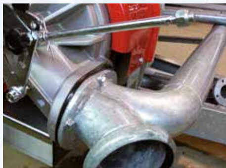
Warstwa przezroczystego lakieru zwiększająca ochronę części ocynkowanych.
