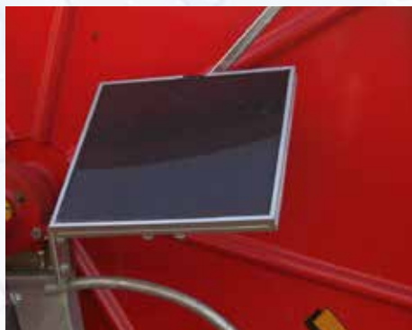
Panel słoneczny do zasilania urządzeń elektronicznych.
