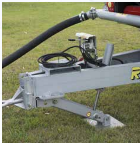
Hydrauliczna przechyłana stopa steru (opcjonalna dla 790, 890, 990 i 1100 GX).
