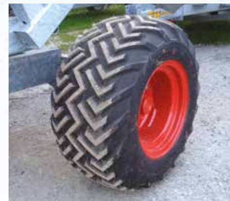
Opony flotacyjne dla modeli: 690 Gx Evo i 790 Gx, rozmiar 31x15.50-15.
