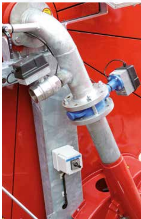
Elektromechaniczne zawory: wylotowy i zamykający sterowane przez programator (dostarczane oddzielnie bądź połączone z przełącznikiem elektrycznym i przez niego sterowane).
