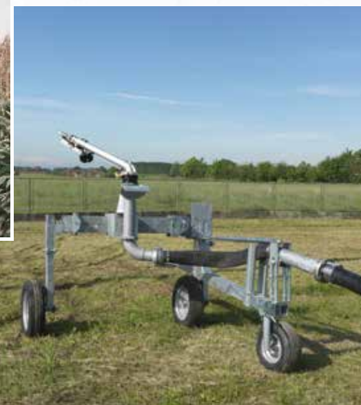
Wysięgnik do rozwijania tylnego węża (w opcji dla modeli 790 Gx, 890 Gx, 990 Gx, 1100 Gx), w standardzie dla 1200 Fx.
