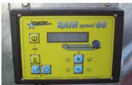
Cyfrowy licznik metrażu Rain Speed 60 do pomiaru prędkości nawijania węża.
