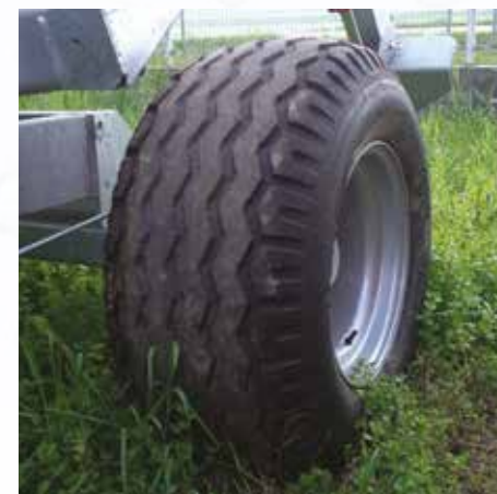
Opony flotacyjne dla modeli: 890 Gx, 990 Gx, w standardzie dla 1100 Gx (rozmiar 15.0/55-17).
