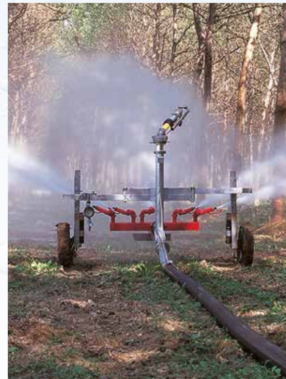
Urządzenie do nawadniania pod koronami wysokich drzew.
