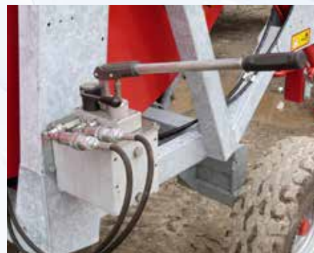
Pompa ręczna do uruchamiania tylnych wsporników i podnoszenia wózka (w opcji dla modeli: 570 Gx Evo, 581 Gx Evo, 690 Gx, 790 Gx).
