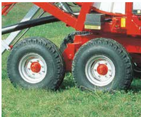
Podwójna oś na wahaczu asymetrycznym (w opcji dla modeli: 690 Gx, 790 Gx, 890 Gx, 890 Gx Evo).
