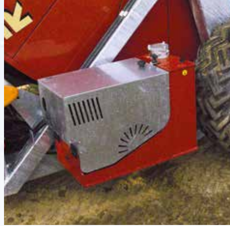
Centralka uruchamiana przez 4-suwowy silnik HONDA GX160 Hp 5,5 do obsługi urządzeń hydraulicznych.
