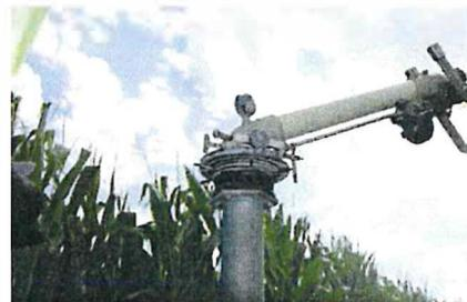
Dettaglio del dispositivo meccanico di regolazione della velocità.
