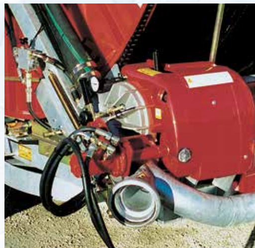
Riavvolgimento del tubo PE mediante motore idraulico su PTO, valvola regolatrice di velocità, distributore finecorsa e coppia innesti rapidi al trattore
