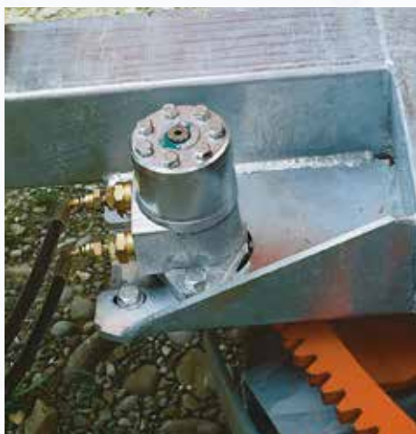
Rotazione idraulica della ralla (di serie su tutti i modelli ad esclusione di 600 Xj, 700 Xj, 600 Xjm).
