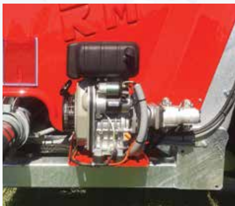
Centralina azionata da motore a 4 tempi HONDA GX160 oppure Briggs & Stratton Hp 5,5 per servizi oleodinamici.
