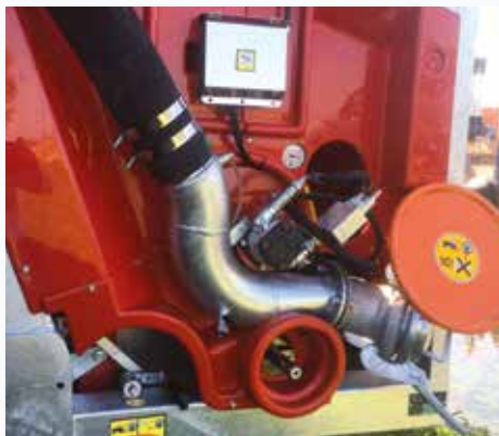
Riavvolgimento del tubo con motore diesel YANMAR LD70 completo di trasmissione idrostatica con motore idraulico sul riduttore, valvola compensatrice di velocità, doppia pompa idraulica per alimentazione dei servizi; abbinabile a programmatori elettronici RM. L'optional sostituisce il riavvolgimento a turbina.
