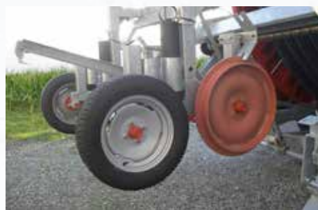
Carrello con due ruote pneumatiche e due ruote in ghisa.
