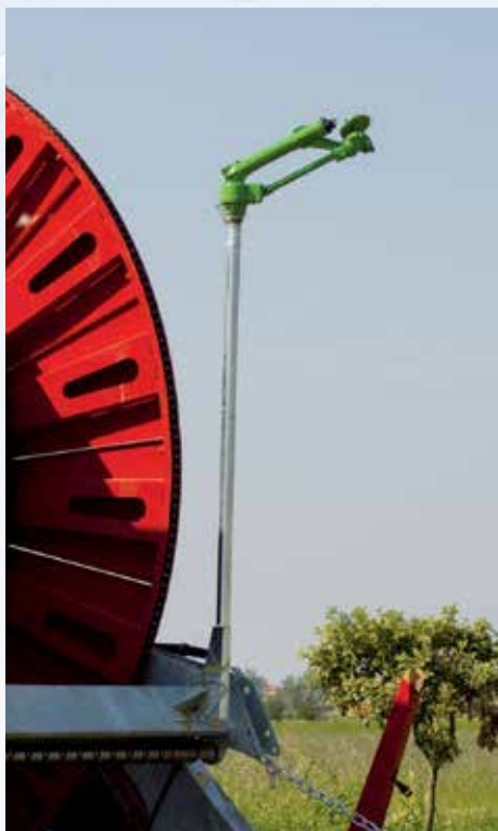
Gettino supplementare di fine corsa comandato da programmatore (mod. Skipper oppure K1).
