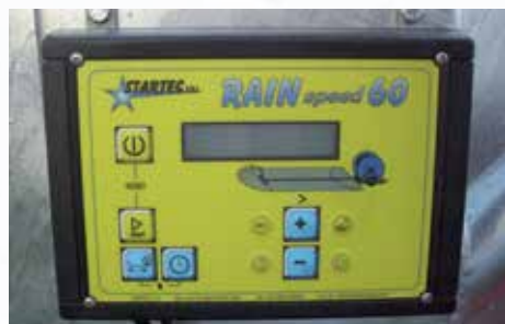
Contametri digitale Rain Speed 60 per la misura della velocità di riavvolgimento.
