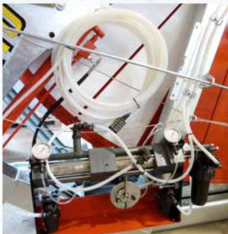
Pompa dosatrice per fertilizzazione con concime liquido.
