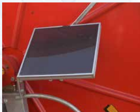
Pannello solare per alimentazione degli apparati elettronici
