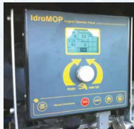
Programmatore IDROMOP per gestione congiunta macchina irrigatrice + motore diesel su modelli XJM.
