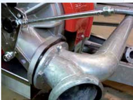
Verniciatura trasparente per aumentare la protezione delle parti zincate.
