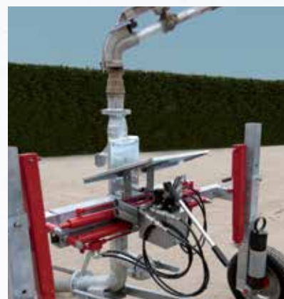
Regolazione idraulica larghezza carrello e registrazione meccanica dell'altezza ruote.
