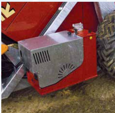
Centralina azionata da motore a 4 tempi HONDA GX160 oppure Briggs & Stratton Hp 5,5 per servizi oleodinamici.
