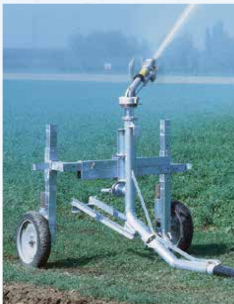
Carrello con ruote pneumatiche di serie su mod. XJ.
