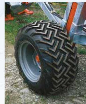
Pneumatico alto galleggiamento per mod. 600 Xj, 700 Xj (misura 31x15.50-15)
