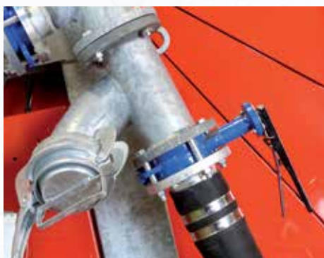
Attacco supplementare per ingresso liquame ed esclusione turbina.
