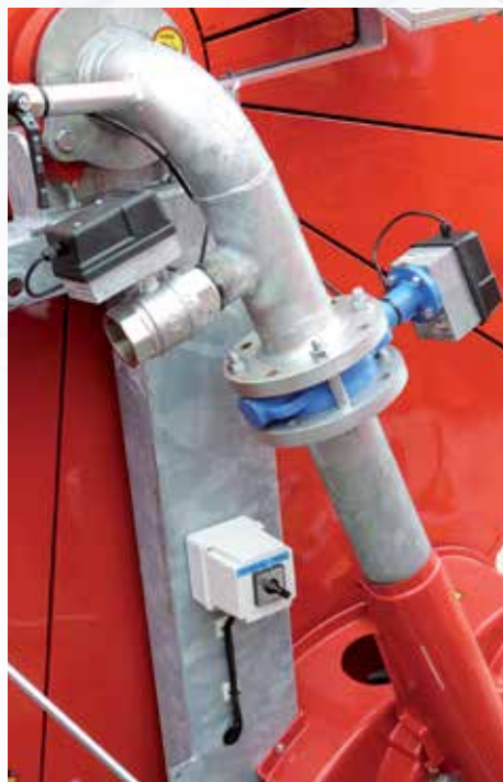
Valvola di scarico elettromeccanica e valvola di chiusura elettromeccanica comandate da programmatore (fornibili separate oppure associate e comandate da commutatore elettrico).
