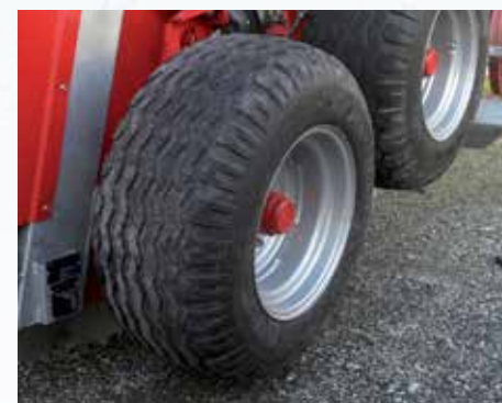
Pneumatico alto galleggiamento per mod. 800 jX, 840 Xj, 900 Evo due assi, 900 Xjm, Major Evo, Major Xjm Evo (misura 15.0/55-17)
