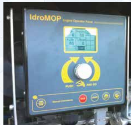
Programmeur IDROMOP pour gestion conjointe enrouleur+ moteur diesel sur modèles XJM.
