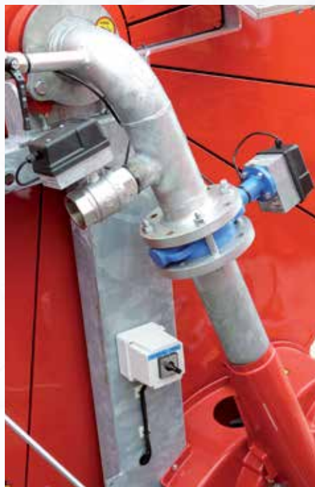
Vanne de décharge électromécanique et vanne de fermeture électromécanique commandées par un programmeur (disponibles séparées ou bien associées et commandées par un commutateur électrique).
