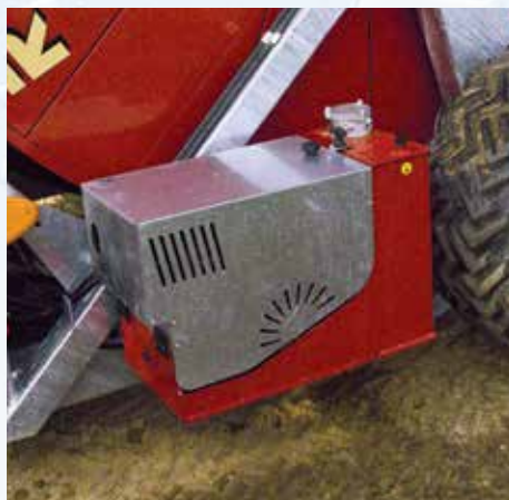
Unité de commande actionnée par un moteur à 4 temps HONDA GX160 ou bien Briggs & Stratton Hp 5,5 pour des services oléodynamiques.
