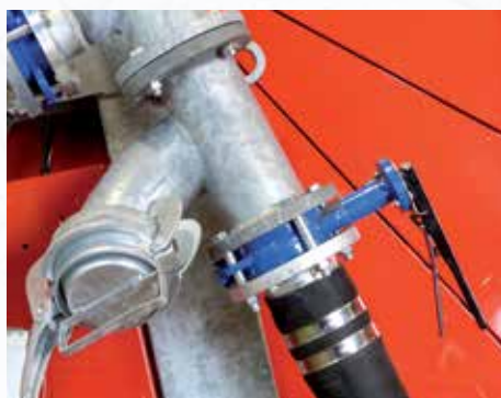
Manchon supplémentaire pour entrée lisier et exclusion turbine
