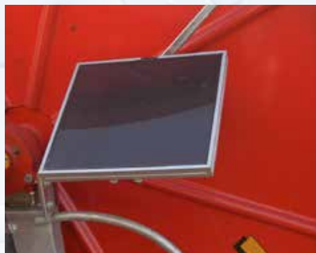
Panneau solaire pour alimentation des appareils électroniques
