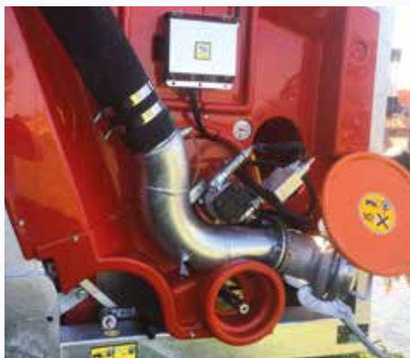
Enroulement du tuyau avec moteur diesel YANMAR L70 sans turbine, complet de transmission hydrostatique avec moteur hydraulique sur réducteur; valve compensatrice de vitesse, double pompe hydraulique pour alimentation des services, qu'on peut accoupler à des programmeurs électroniques RM. Le produit en option remplace l'enroulement à turbine.
