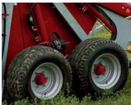
Double essieu sur boggie asymétrique (en option pour mod. 800 Xj, 840 Xj, 900 Evo, 800 XJM).
