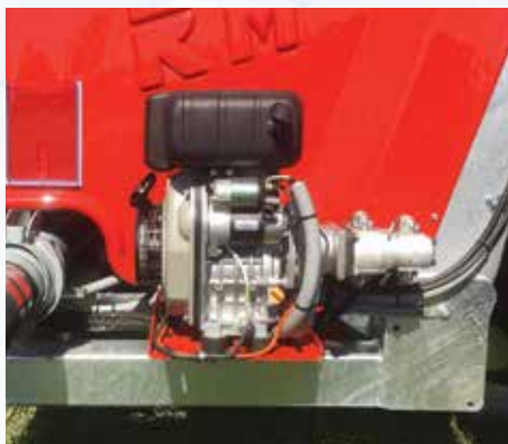
Unité de commande actionnée par un moteur à 4 temps HONDA GX160 ou bien Briggs & Stratton Hp 5,5 pour des services oléodynamiques.
