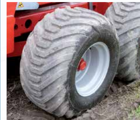
Pneumatique basse pression pour mod. Magnum Xj, Magnum Xjm, Magnum Giant (mesure 500/50-17)
