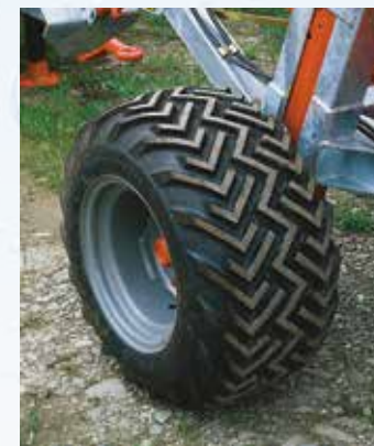
Pneumatique basse pression pour mod. 600 Xj, 700 Xj (mesure 31x15.50-15)
