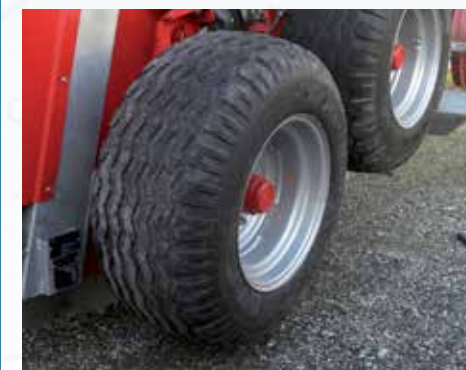
Pneumatique basse pression pour mod. 800 jX, 840 Xj, 900 Evo deux axes, 900 Xjm, Major Evo, Major Xjm Evo (mesure 15.0/55-17)
