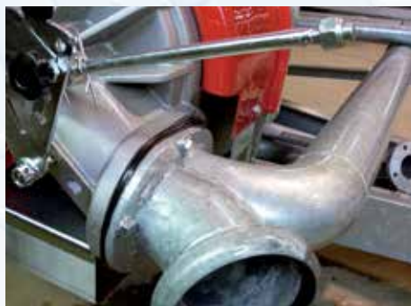
Vopsea transparentă pentru a spori protecția părților zincate.
