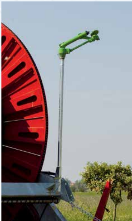
Aspersor suplimentar de sfârșit de cursă comandat de programator (mod. Skipper sau KI).
