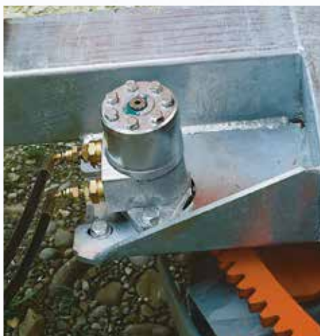
Rotire hidraulică a balamalei (standard pe modelele 990 Gx, 1000 Gx, opțional pentru toate celelalte).
