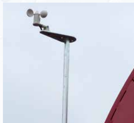
Anemometru pentru RAINMASTER 2.6.
