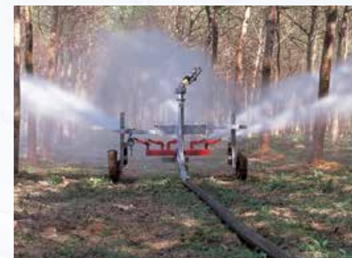
Dispozitiv de irigație sub frunzișul arborilor cu tulpină înaltă.
