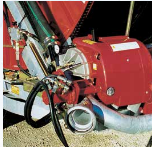
Nawijanie węża PE za pomocą silnika hydraulicznego połączanego do WOM, zawór regulujący prędkość, rozdzielacz z wyłącznikiem krańcowym oraz para szybkozłączny do ciągnika.
