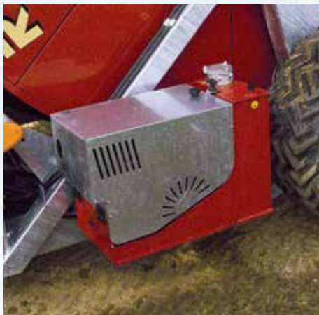
Centralka uruchamiana przez 4-suwowy silnik HONDA GX160 lub Briggs & Stratton Hp 5,5 do obsługi urządzeń hydraulicznych.
