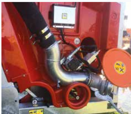
Nawijanie węża za pomocą silnika diesel YANMAR LD70 wyposażonego w przekładnię hydrostatyczną z silnikiem hydraulicznym połączonym z przekładnią, zawór kompensacyjny prędkości, podwójna pompa hydrauliczna do zasilania urządzeń; możliwość połączenia z programatorami elektronicznymi RM. Opcja zastępuje nawijanie turbinowe.
