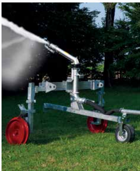
Wagen met afzonderlijke gietijzeren wielen (optioneel vanaf het model 570 Gx Evo).
