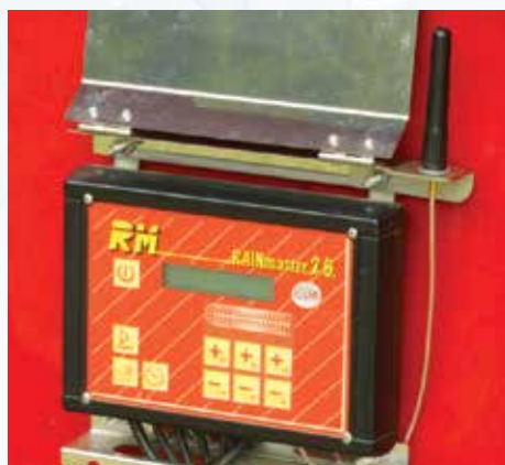
Controlesysteem RM model RainMaster 2.6 (met antenne en ingebouwde GSM module)
