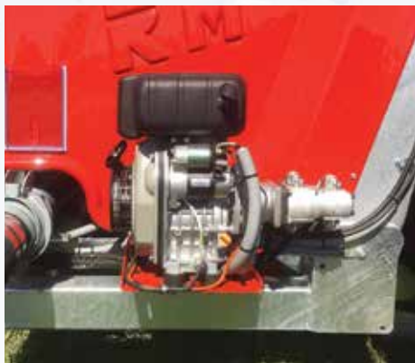
Centrale aangestuurd door 4-taktmotor HONDA GX160 of Briggs & Stratton Pk 5,5 voor oleodynamische voorzieningen.
