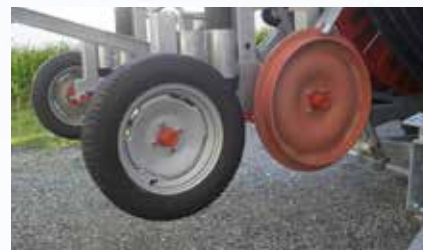
Wagen met twee luchtbanden en twee gietijzeren wielen.
