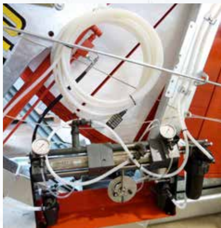
Doseerpomp met vloeibare meststof voor fertigatie.
