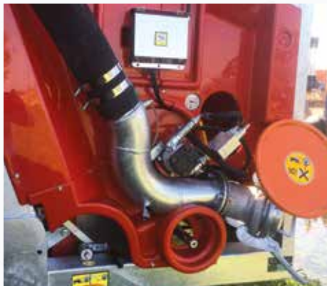
Oprollen van de slang met YANMAR LD70 dieselmotor; compleet van hydrostatische transmissie met hydraulische motor op de vertragskast, compensatieklep voor de snelheid, dubbele hydraulische pomp voor de voorzieningen. Mogelijke combiwerking met RM elektronische controlesystemen. De optional vervangt de turbinewikkeling.
