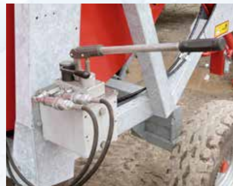
Handpomp voor activering van de achterste steunvoeten en heffen van de wagen (optioneel voor de modellen 570 Gx Evo, 581 Gx Evo, 690 Gx, 790 Gx).
