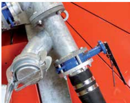
Extra aansluiting voor ingang vloeibare mest en uitsluiting turbine.
