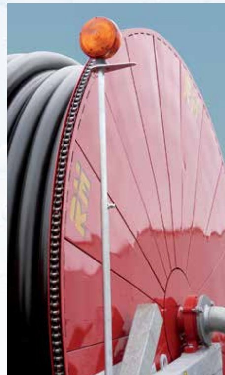
Melding van einde slangafwinding via xenonlamp voor RM controlesysteem.
