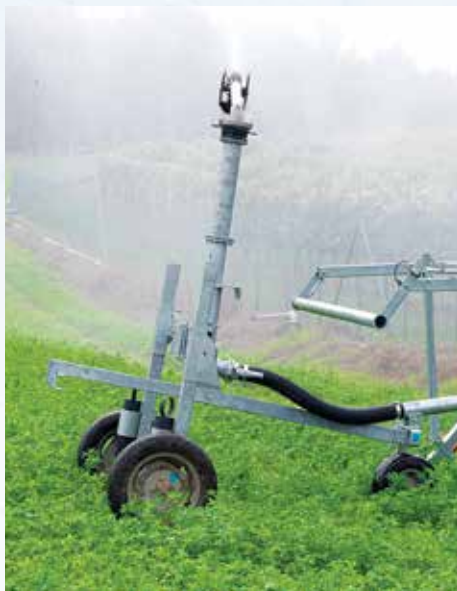
Wagen met drie standaard luchtbanden op alle Gx modellen.
