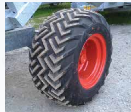
Band met hoogrijfvermogen voor model 690 Gx Evo en 790 Gx maat 31x15.50-15.
