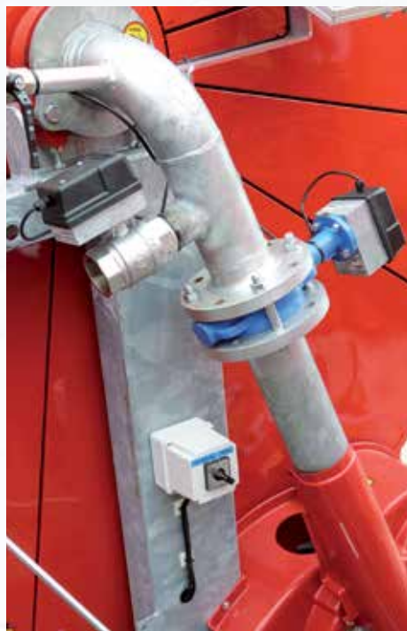
Elektromechanische ontladklep en elektromechanische sluitklep, gestuurd door het controlesysteem (leverbbaar gescheiden of in combinatie en gestuurd door elektrische schakelaar).
