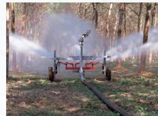
Apparaat voor irrigatie onder het gebladerte van hoge bomen.
