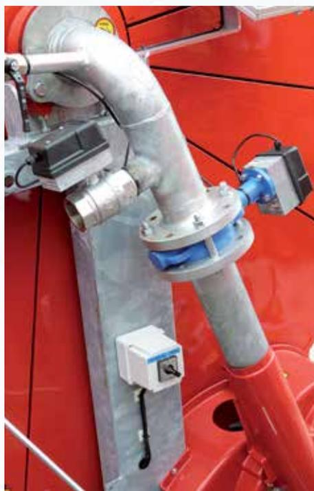
Выпускной электромеханический клапан и клапан запорный электромеханический, управляемые программатором (поставляются отдельно или вместе и управляются электрическим выключателем)
