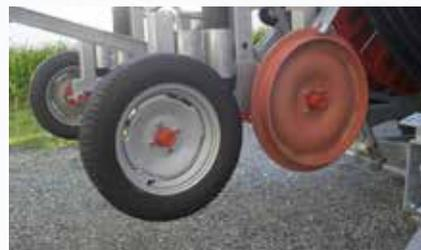
Тележка с двумя пневматическими и двумя чугунными колесами.
