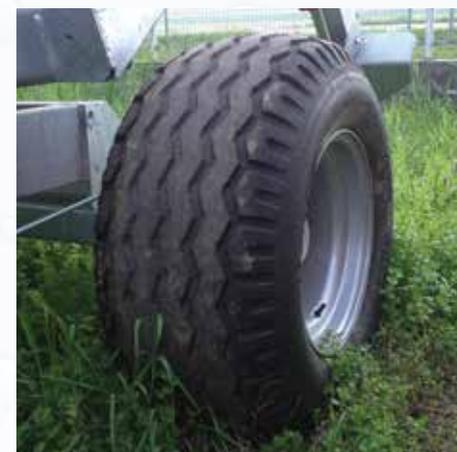
Шины высокой флотации для мод. 890 Gx, 990 Gx, серийно на 1000 Gx (размер 15.0/55-17)
