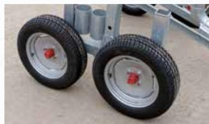
Тележка с четырьмя пневматическими колесами
