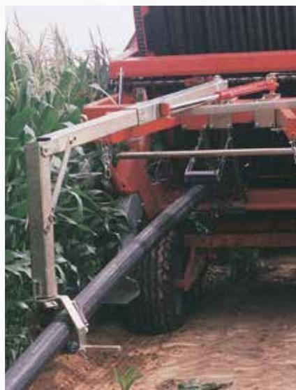
Кронштейн для задней размотки шланга (опция для моделей 790 Gx, 890 Gx, 990 Gx, 1000 Gx), в комплектации на Magnum Fx
