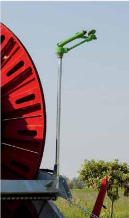
Дополнительный отвод на конце, управляемый программатором (модель Skirreg или K1).
