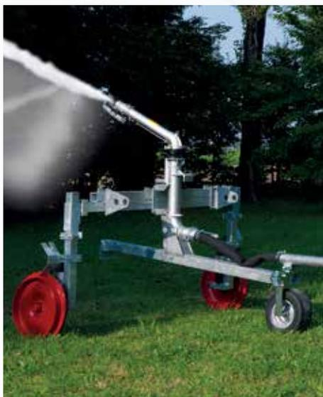
Тележка с чугунными одиночными колесами (опционально начиная с модели 570 Gx Evo)
