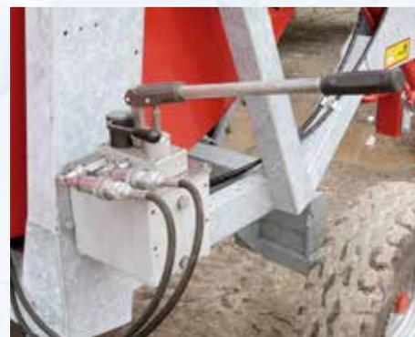
Ручной насос для запуска задних кронштейнов и поднятия тележки (опция для моделей 570 Gx Evo, 581 Gx Evo, 690 Gx, 790 Gx).
