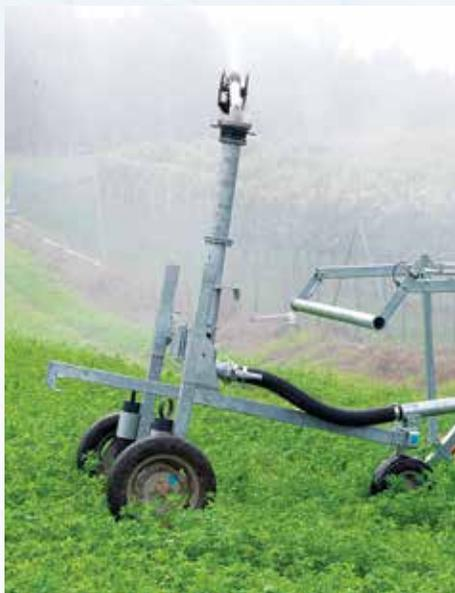
Тележка с тремя пневматическими колесами стандартной комплектации на всех моделях Gx.
