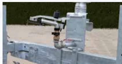
Дополнительный отвод K1 под напряженным углом, установленным на тележку
