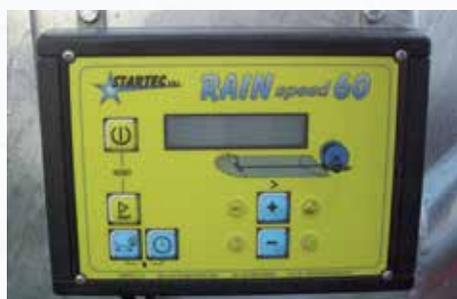
Электронный счетчик Rain Speed 60 для измерения скорости перемотки.
