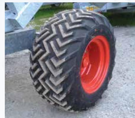
Шины высокой флотации для мод. 690 Gx Evo е 790 Gx размер 31x15.50-15
