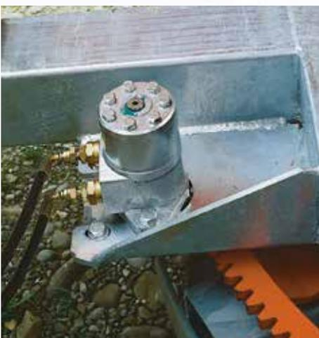
Гидравлическое вращение кольца (в комплектации на моделях 990 Gx, 1000 Gx, в опциях для остальных).
