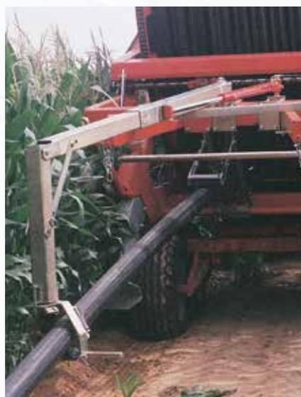
Braccio per srotolamento posteriore del tubo (opzionale per modelli 790 Gx, 890 Gx, 990 Gx, 1000 Gx), di serie su Magnum Fx.
