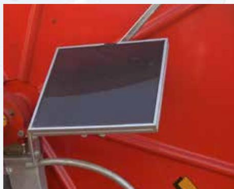
Pannello solare per alimentazione degli apparati elettronici
