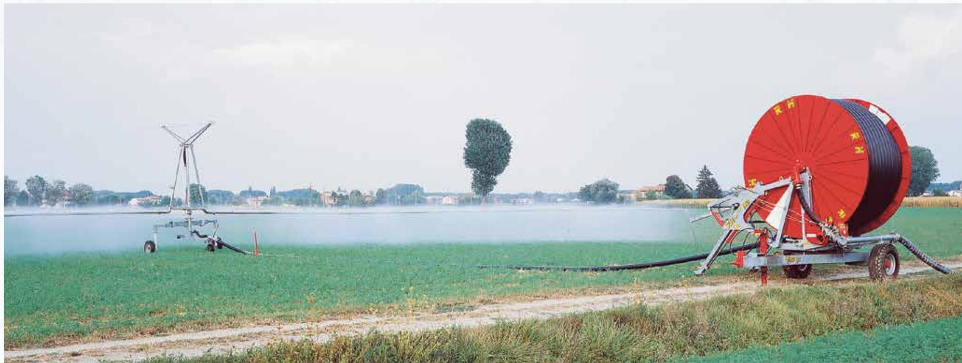
Ala in acciaio con struttura da 50 metri montata su 890 Gx
