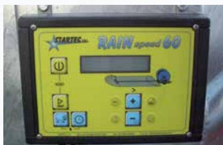
Contometri digitale Rain Speed 60 per la misura della velocità di riavvolgimento.
