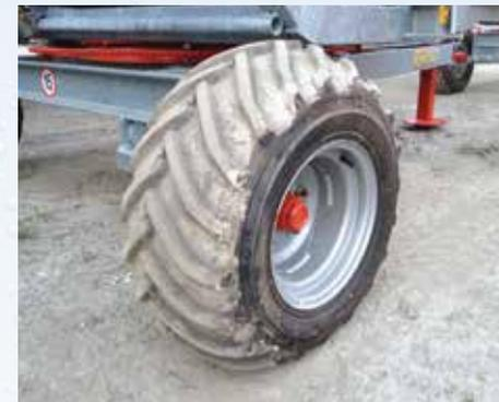
Pneumatico alto galleggiamento per mod. 581 Gx Evo misura 26/12.00-12
