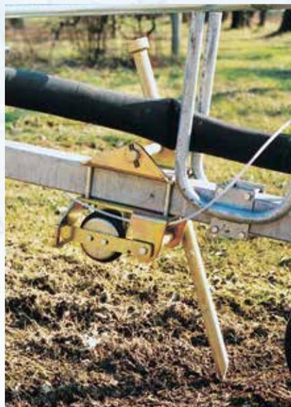
Dispositivo per bloccaggio carrello a terra con piccozza (per modelli con srotolamento posteriore del tubo)
