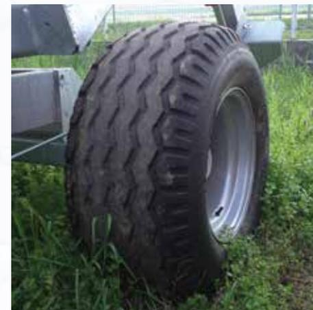
Pneumatico alto galleggiamento per mod. 890 Gx, 990 Gx, di serie su 1000 Gx (misura 15.0/55-17)
