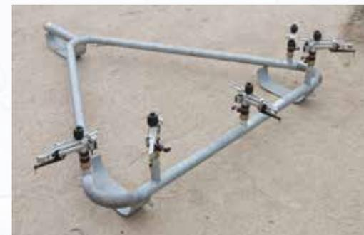
Dispositivo per irrigazione sotto-chioma per frutteti/vigneti in sostituzione del carrello standard.
