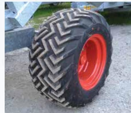
Pneumatico alto galleggiamento per mod. 690 Gx Evo e 790 Gx misura 31x15.50-15
