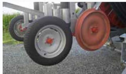
Carrello con due ruote pneumatiche e due ruote in ghisa.
