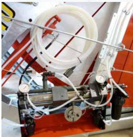
Pompa dosatrice per fertirrigazione con concime liquido.
