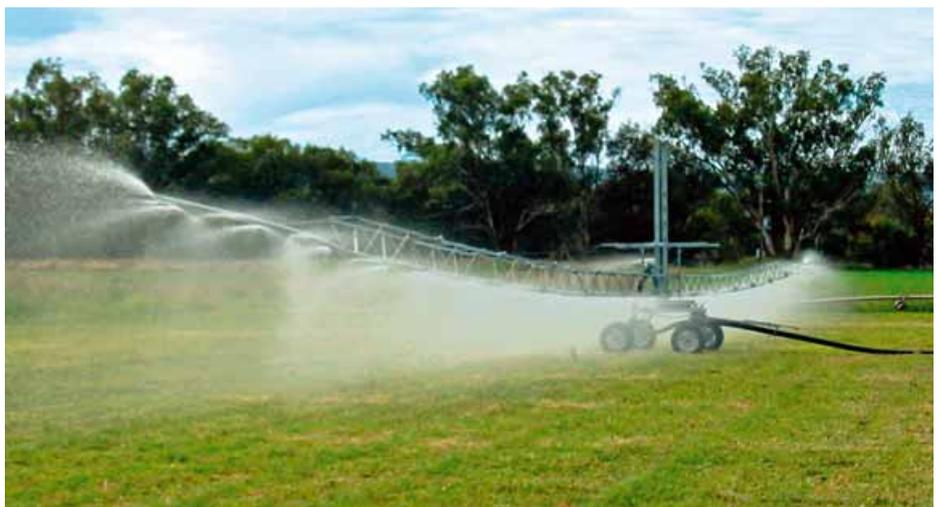
**Foto 2** - Particolare dell'ala piovana. Funziona con bassissima pressione di esercizio (1,5 atm), con erogazione molto localizzata a livello del suolo e distribuzione uniforme in ogni situazione
