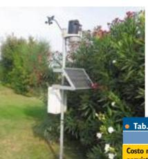
La centralina meteorologica aziendale è una risorsa importante per l'agricoltore in quanto riesce a fornire indicazioni precise sul livello di evotraspirazione, dato di partenza per determinare il momento ideale per iniziare ad irrigare
